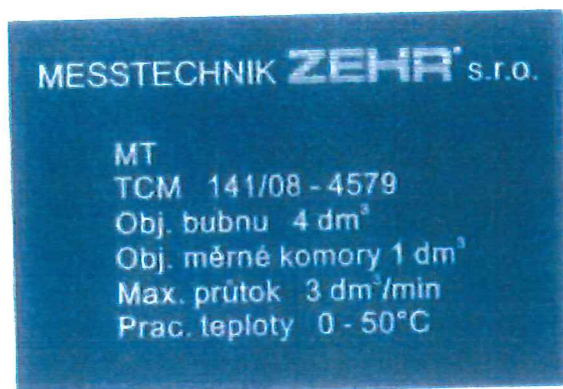
Obr. 5 – Príklad výrobného štítku
